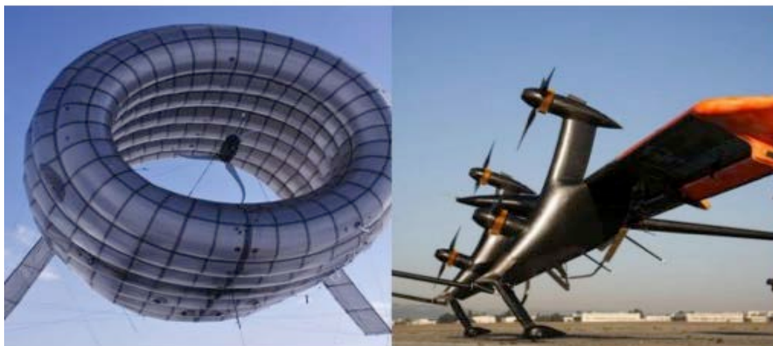
Figura 8: Aerofólio cabeado em modo de arrasto, das empresas Altaeros e Makani Power
