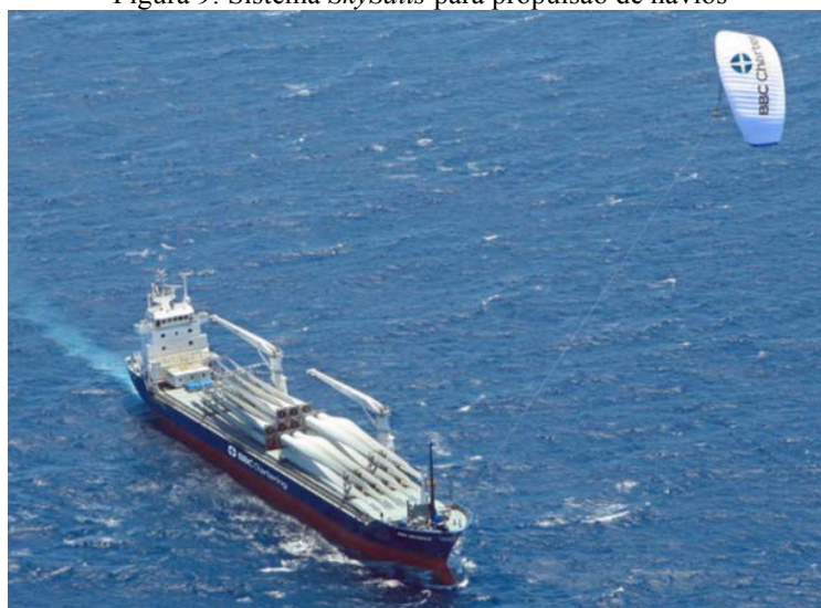
Figura 9: Sistema SkySails para propulsão de navios
